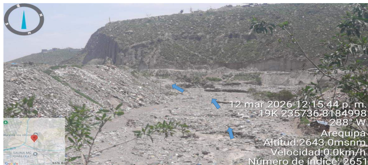
Imagen N° 3. Zona colmatada en el tramo, en donde se observa sedimentación en el cauce de la quebrada El Huarangal.
